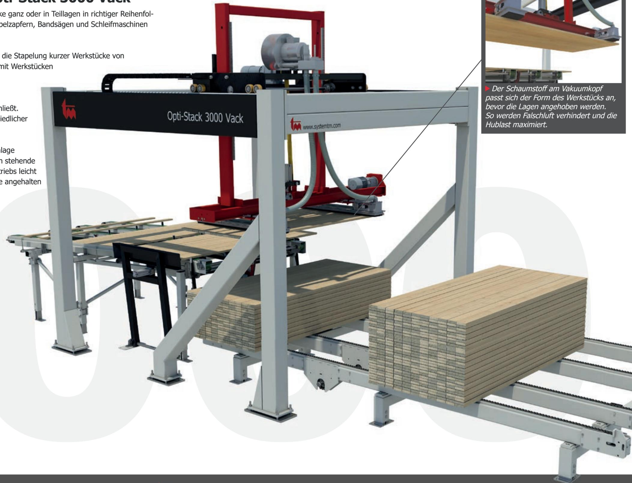
▶ Der Schaumstoff am Vakuumkopf passt sich der Form des Werkstücks an, bevor die Lagen angehoben werden. So werden Falschlufte verhindert und die Hublast maximiert.
