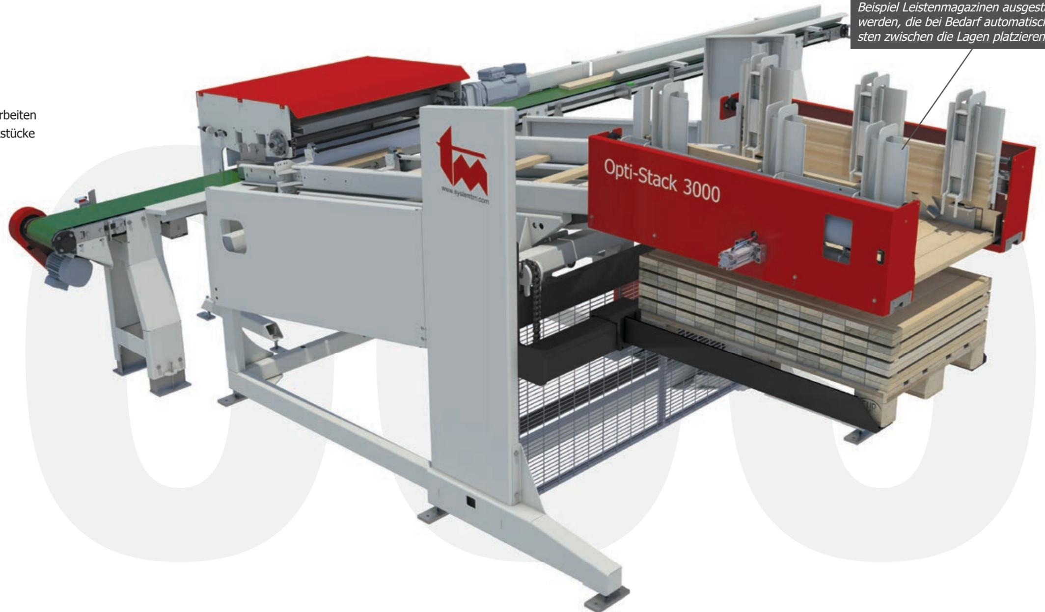
▶ Das mechanische Stapelsystem kann mit optionalen Funktionen wie zum Beispiel Leistenmagazinen ausgestattet werden, die bei Bedarf automatisch Leisten zwischen die Lagen platzieren.
