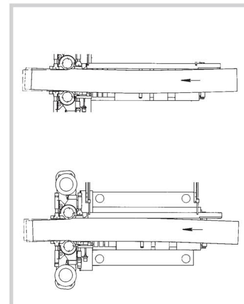
**Das REX PSV-System (schwimmende Vertikalwellen)**
