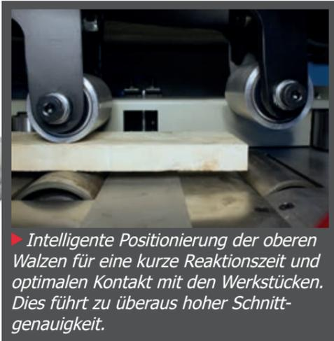
► Intelligente Positionierung der oberen Walzen für eine kurze Reaktionszeit und optimalen Kontakt mit den Werkstücken. Dies führt zu überaus hoher Schnittgenauigkeit.
