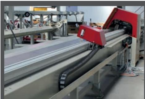
► Der Schubarm wird von einem linearen Modul mit Servoantrieb gesteuert, das hohe Kapazität und Schnittgenauigkeit bei minimaler Wartung erzielt
