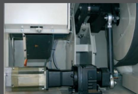
► Die Bewegung des Sägeblatts erfolgt über eine Servo-Nockensteuerung, die jederzeit für eine steuerbare Hochleistung und hohe Schnittqualität sorgt.
