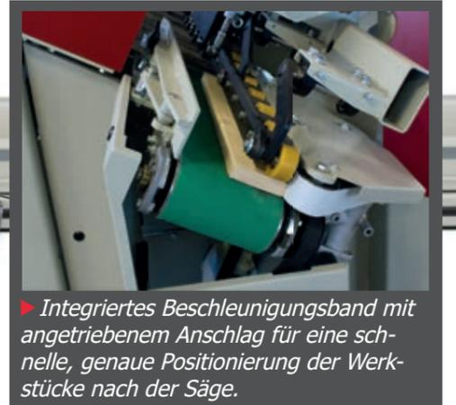
► Integriertes Beschleunigungsband mit angetriebenem Anschlag für eine schnelle, genaue Positionierung der Werkstücke nach der Säge.
