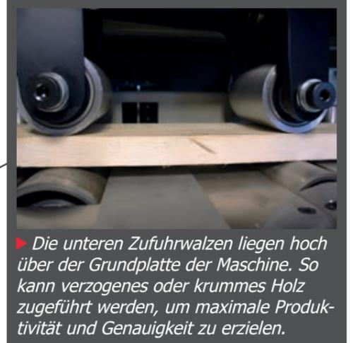
► Die unteren Zufuhrwalzen liegen hoch über der Grundplatte der Maschine. So kann verzogenes oder krummes Holz zugeführt werden, um maximale Produktivität und Genauigkeit zu erzielen.
