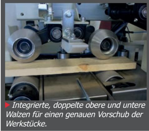
► Integrierte, doppelte obere und untere Walzen für einen genauen Vorschub der Werkstücke.
