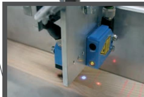
► Mit einer Rücklaufgeschwindigkeit von 310 m/Min. registrieren die Sensoren Defekte, Qualität und Abmessungen der Bretterlänge
