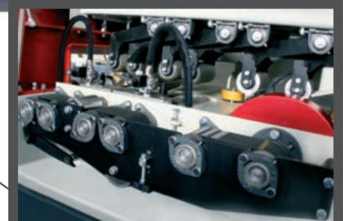
► Ein breites Zeitband mit Servoantrieb an der Unterseite der Walzen gewährleistet die Schnittgenauigkeit. Dieses Hochleistungsdesign hat sich als extrem strapazierfähig erwiesen und erfordert nur ein geringes Maß an Wartung.
