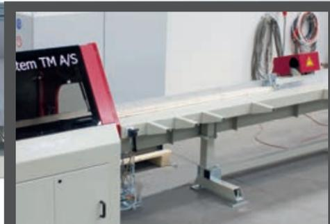
► Hochgeschwindigkeits Schubarm mit einer Zufuhrgeschwindigkeit von 140 m/Min. und einer Rücklaufgeschwindigkeit von 310 m/Min.
