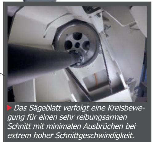
► Das Sägeblatt verfolgt eine Kreisbewegung für einen sehr reibungsarmen Schnitt mit minimalen Ausbrüchen bei extrem hoher Schnittgeschwindigkeit.
