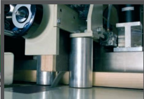
► Starke Andruckeinheit und intelligente Seitenwalzen sorgen für ein genaues Positionieren und Zuschneiden des Werkstücks während des Sägevorgangs
