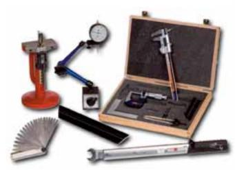
Nur mit den richtigen Messmitteln kann richtig gemessen werden. Bei dem Schleifen der Werkzeuge wird im Bereich von Hundertstel gearbeitet. Diese kleinen Bereiche erfordern besondere Messwerkzeuge, auch diese liefert REX. Digitale Messschieber, Drehmomentschlüssel, Messuhren, Haarlineale, Winkel, Mikrometer, um nur einige zu nennen.
