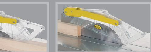
Die Schutzhaube durch das zu sägende Material vorne an und beim Schnitt senkt sich die Schutzhaube wieder auf. Dies führt nachweislich zu einer erheblichen Reduzierung des Staubes.
