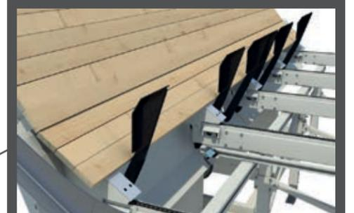
▶ Das mechanische Beschickungssystem kann mit optionalen Erweiterungen ausgestattet werden, wie zum Beispiel Kantenschutz und Lärmdämmung.
