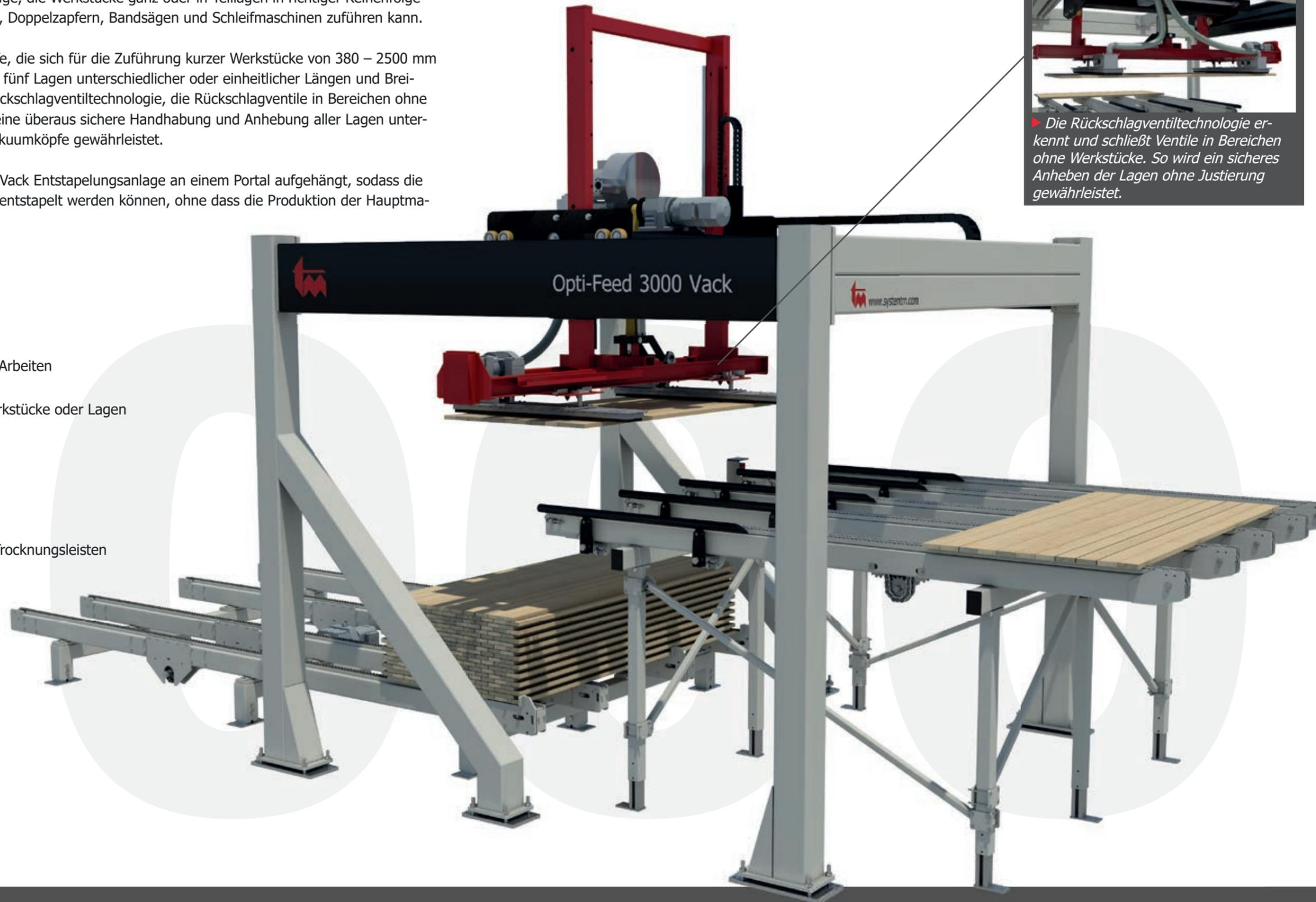
▶ Die Rückschlagventiltechnologie erkennt und schließt Ventile in Bereichen ohne Werkstücke. So wird ein sicheres Anheben der Lagen ohne Justierung gewährleistet.
